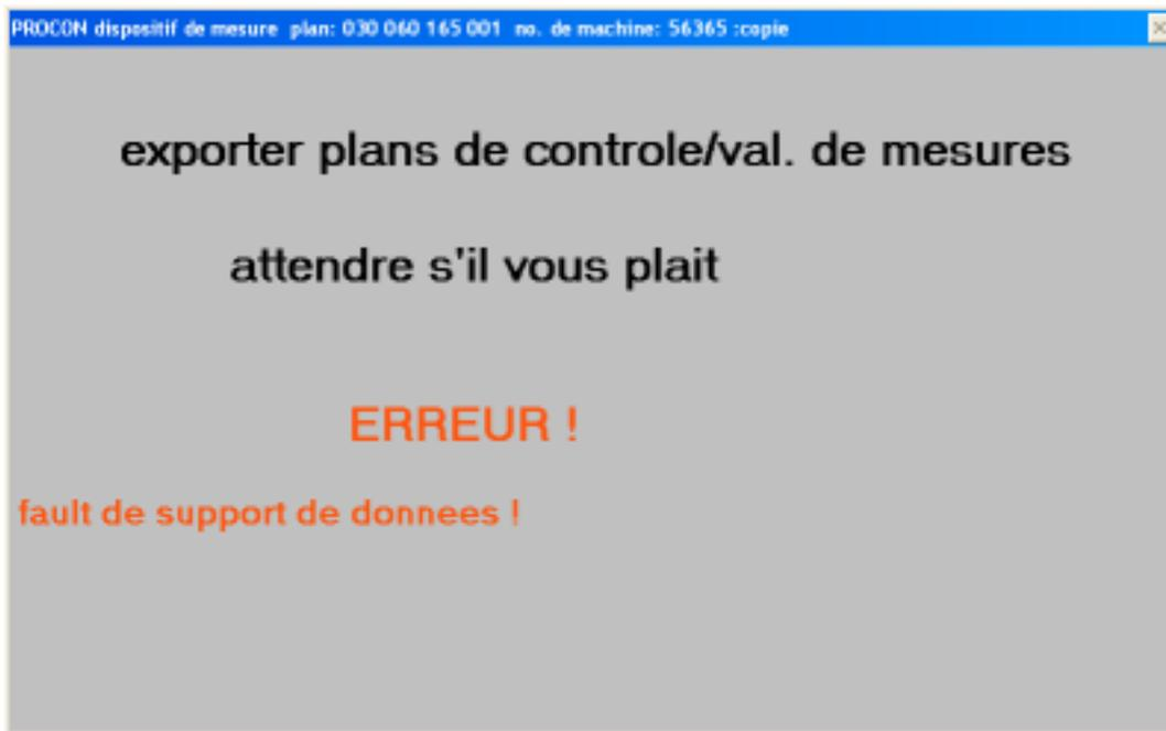
Si une clé USB est connectée, les fichiers de valeurs de mesure sont exportés dans le répertoire principal de la clé USB. Les plans de contrôle sont sauvegardés dans le dossier \prplan sur la clé USB. Si ce dossier n'existe pas encore, il est créé automatiquement.
